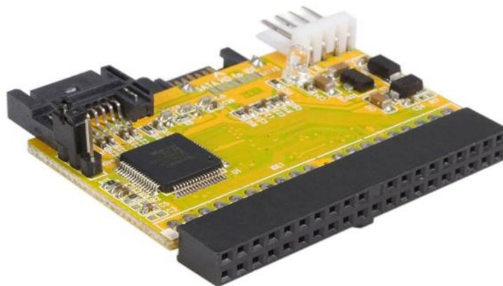
Questo kit adattatore per unità IDE a SATA mette a disposizione un semplice metodo di installazione per dischi rigidi Serial ATA sfruttando una porta IDE libera: una soluzione conveniente per utilizzare i dischi SATA di nuova generazione su computer meno recenti o che non dispongono di altre connessioni SATA libere.
